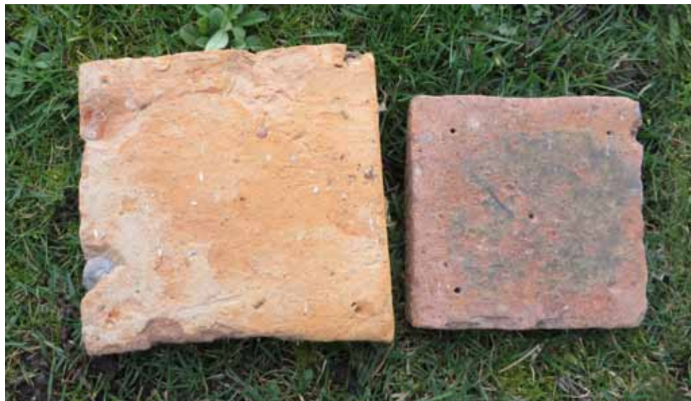
Fig. 6. Verschillende maten plavuizen. Soms bleef er na de winter toch nog rommel achter in de klei; in de linker plavuis werden kleine kiezelsteentjes meegebakken. De plavuizen zijn gevonden in de Kleibosch (eigendom van J. Ensing, foto Jan Battjes).
